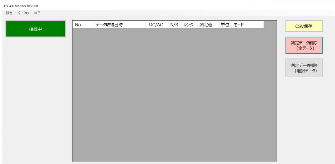
9) GV-400B データ送信ボタンを押下すると測定データが以下の画面に表示される。
