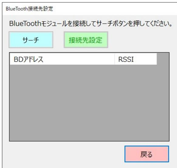
6) サーチボタンを押し接続先をサーチする。接続先が見つかりると以下の画面が表示される。サーチボタン押下でエラーが出た場合下記「サーチボタンエラー時の対応」参照。
