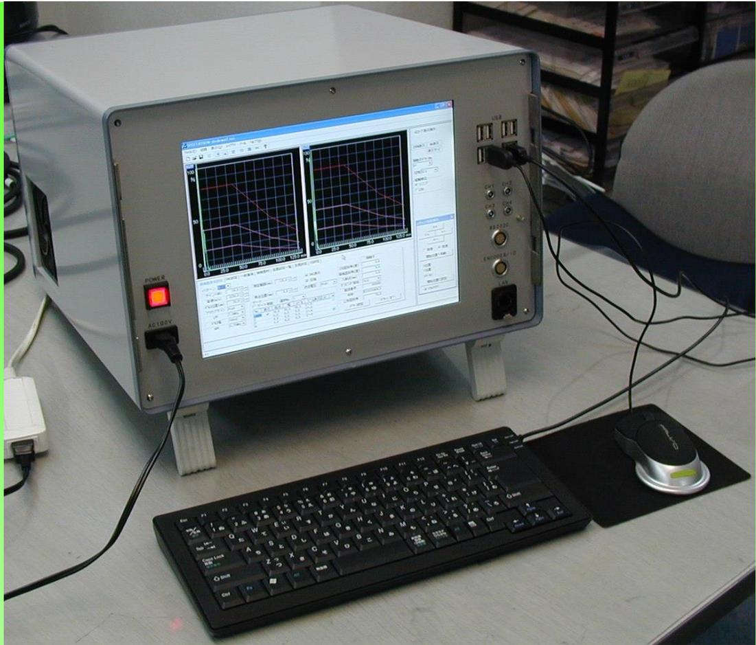
全波形収録方式の自動探傷用超音波探傷器です。4chのマルチch探傷器です。一般的な自動探傷器と異なり、探傷器内に最新のパソコンを内蔵しPCI Expressバスでは径転送することにより高速探傷を実現しています。
