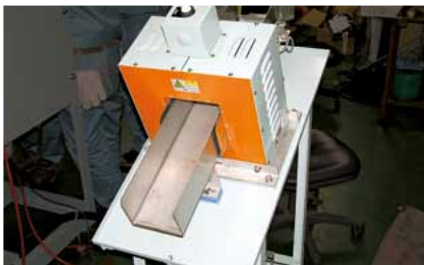
シュート式 は、被脱磁物の自重を利用して ステンレス製シューター内を落下させて脱磁を行う
